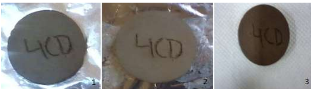
Figura 12 - Corpos de prova com 25% de lodo na argila. 1) Após moldagem; 2) Após secagem a 110 °C; 3) Após queima a 1100 °C. Fonte: Arquivo pessoal.
