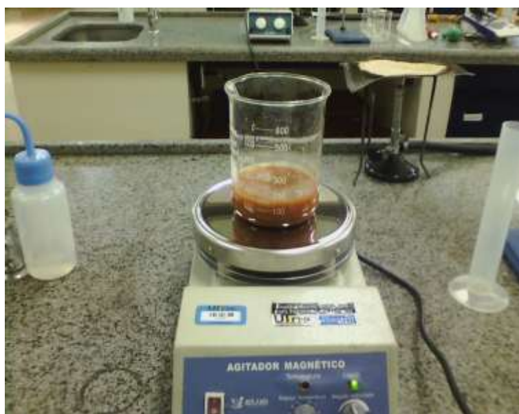
Figura 14 - Processo de lixiviação realizado com as amostra. Fonte: Arquivo pessoal.
