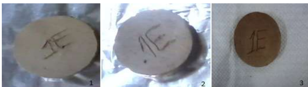
Figura 11 - Corpos de prova com 15% de lodo na argila. 1) Após moldagem; 2) Após secagem a 80 °C; 3) Após queima a 1000 °C. Fonte: Arquivo pessoal.
