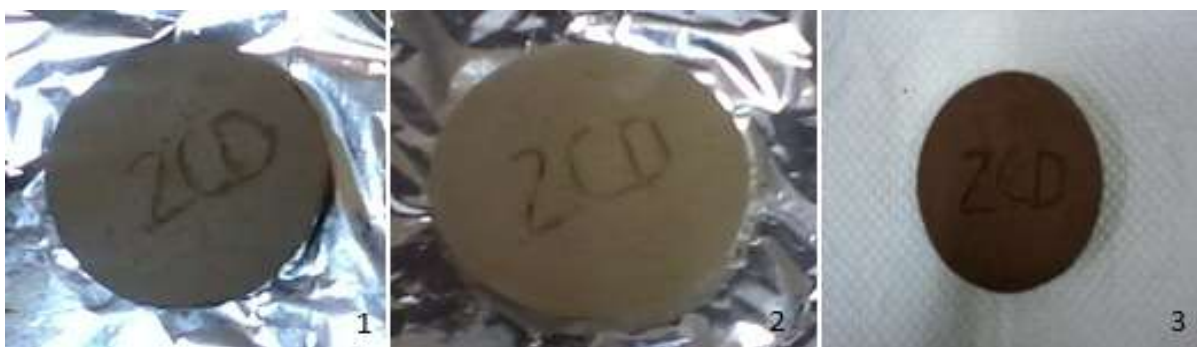
Figura 10 - Corpos de prova com 5% de lodo na argila. 1) Após moldagem; 2) Após secagem a 110 °C; 3) Após queima a 1100 °C. Fonte: Arquivo pessoal.
