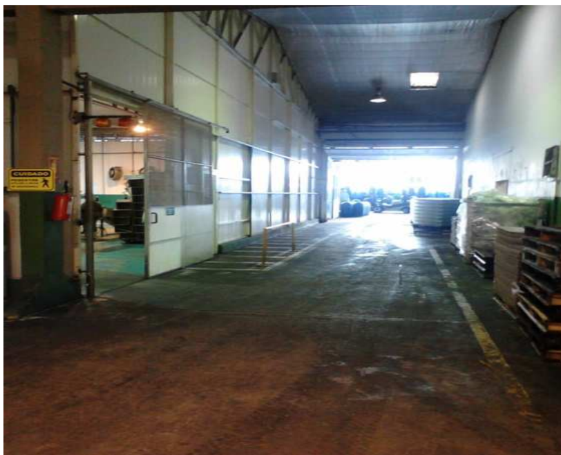
Figura 2: Aplicação NR -11 - sinal luminoso e guarda corpo.
