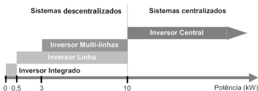
Figura 4 – Sistemas e potência de geração de energia em sistemas fotovoltaicos conectados a rede.
