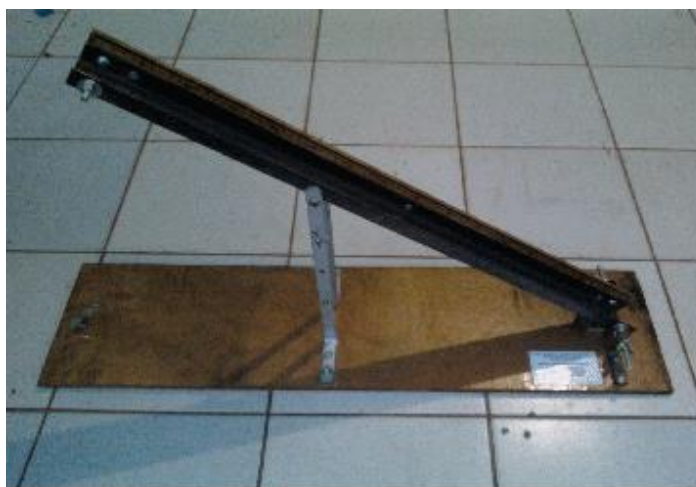
Figura 1. Experimento de Cinemática inclinado e apoiado sobre a haste de 35cm de altura a 45°.
