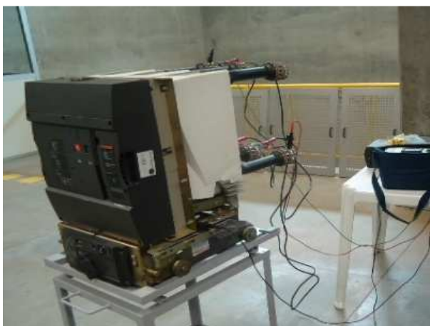
Figura 3: Ensaio no disjuntor de grupo do gerador.
